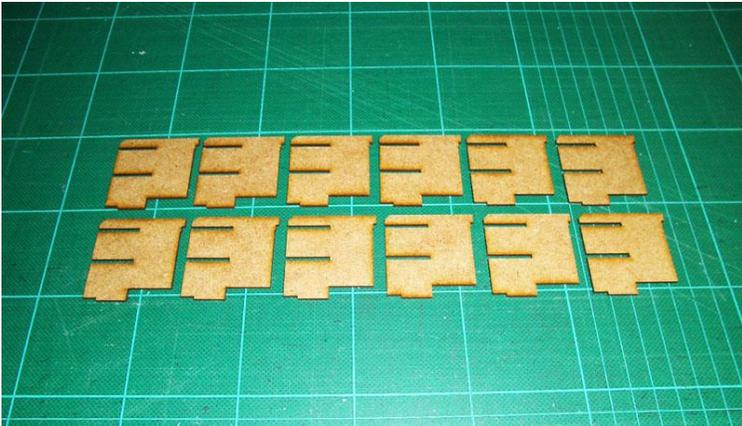
Auch die senkrechte Abteilwand und die bodenplatte die in gleiches MDF Material sind, werden besprüht mit Spachtel.
